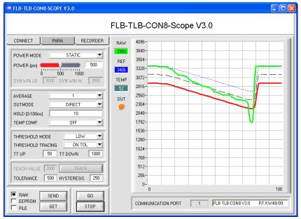
Im Beispiel wurde für TT DOWN ein Wert von 1000 gewählt. Das bedeutet, dass die Schwellennachführung nach unten relativ langsam durchgeführt wird. In der Grafik kann man das an der blauen Referenzlinie deutlich sehen.
