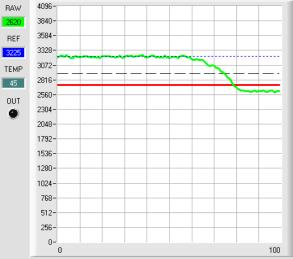
Wenn der aktuelle Messwert RAW (grüne Linie) die Schaltschwelle (rote Linie) unterschreitet, wird der Ausgang OUT0 0V (Fehler). Dies wird über die LED OUT visualisiert
