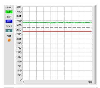
Solange der aktuelle Messwert **RAW** (grüne Linie) oberhalb der Schaltschwelle (rote Linie) liegt, ist der Ausgang **OUT0** auf +24V (Signal ist in Ordnung). Dies wird über die LED **OUT** visualisiert
