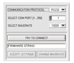
Die Baudrate zur Datenübertragung über die RS232 Schnittstelle kann mit **SELECT BAUDRATE** und **CHANGE BAUDRATE** eingestellt werden.
