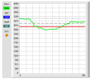
Wird der aktuelle Messwert **RAW** (grüne Linie) wieder größer als die Hystereseschwelle (schwarze Linie), dann wird auch der Ausgang **OUT0** wieder +24V (Signal ist in Ordnung). Dies wird über die LED **OUT** visualisiert
