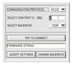
Zum Ändern muss zuerst über TRY TO CONNECT eine Verbindung aufgebaut werden.
